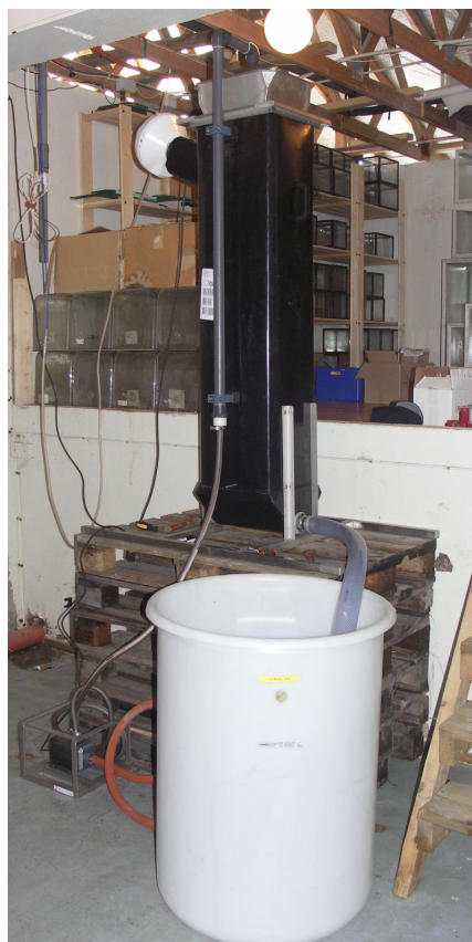
Bilde 1: ACD prototype kolonne lufter til bruk på bedøvelsesvann
